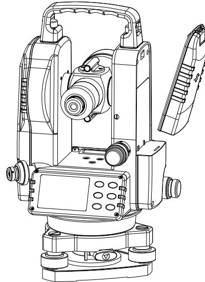
Per installare le batterie nuove o rimuovere le batterie esauste, è necessario agire sul pulsante di sblocco posto sulla sommità del vano batterie, quindi è sufficiente tirare verso di sé il guscio del vano batterie, avendo cura di non rompere i gancetti inferiori in plastica.
