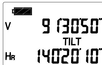
Premere nuovamente il pulsante **V%** per tornare alla modalità di misurazione angoli espressi in gradi.
